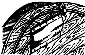
Рис. 10.7. Закрепление нижнего конца ОК на внешней щеке барабана
