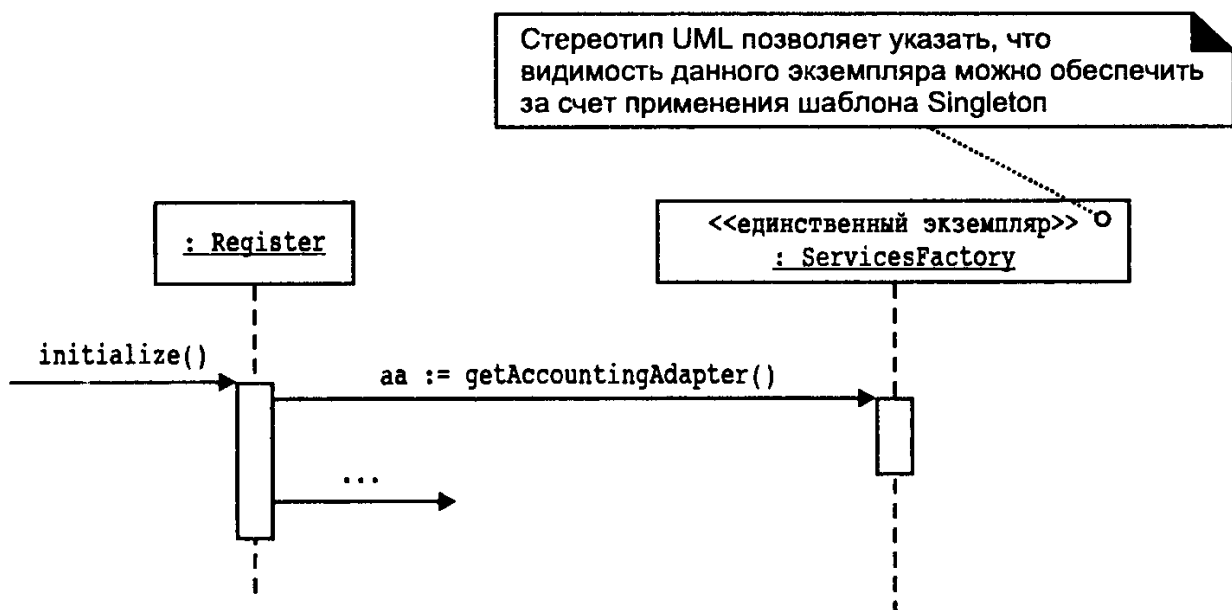
Рис. 23.6. Неявная передача сообщения getInstance , согласно шаблону Singleton , обозначается в UML с помощью стереотипов
