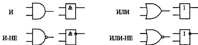
Рис. 2.15. Обозначения элементов И, И-НЕ, ИЛИ, ИЛИ-НЕ: зарубежные (слева) и отечественные (справа).
