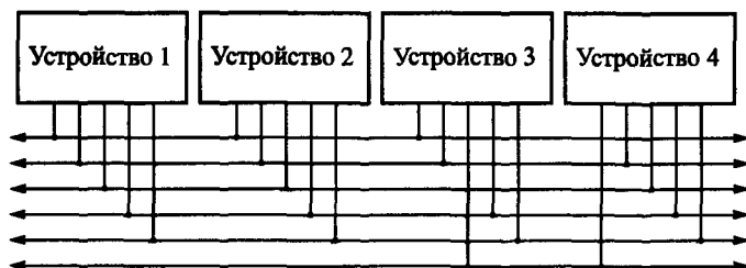
Рис. 1.12. Шинная организация связей.
